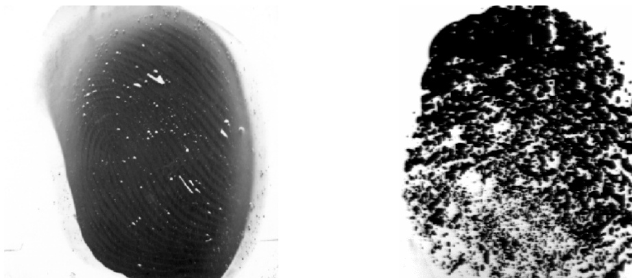
Obr. 5: Příklady otisků prstů s poškozením struktury nečistotou na podkladové ploše (zleva: tekuté mýdlo, detergent)
