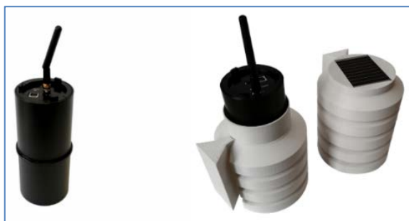
Obr. 6. Radonová sonda pro bytové a venkovní nasazení (vč. solárního dobíjení)
