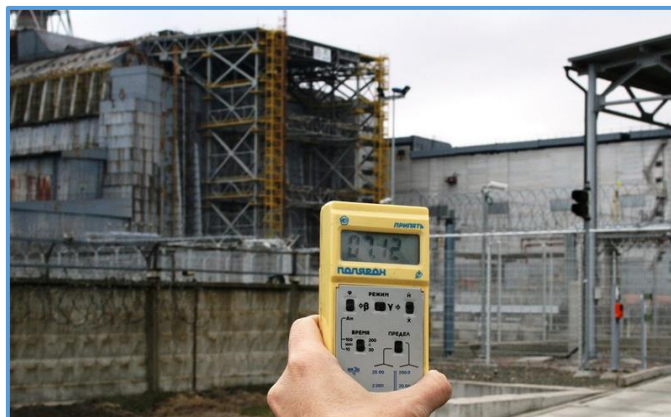
Obr. 11. Radiační úroveň v okolí sarkofágu je stále ještě asi 70-krát vyšší než přírodní pozadí. 1 Dozimetr ukazuje, že ve vzdálenosti asi 300 m od reaktoru je úroveň kolem 7,1 \mu\text{Sv/h} (hodnoty úrovně normálního přírodního pozadí se pohybují kolem 0,1 \mu\text{Sv/h} ).
